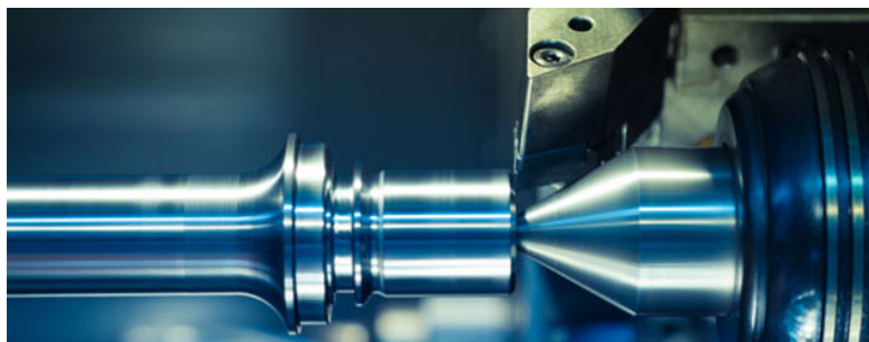
Struženje obdelovanca iz titana
